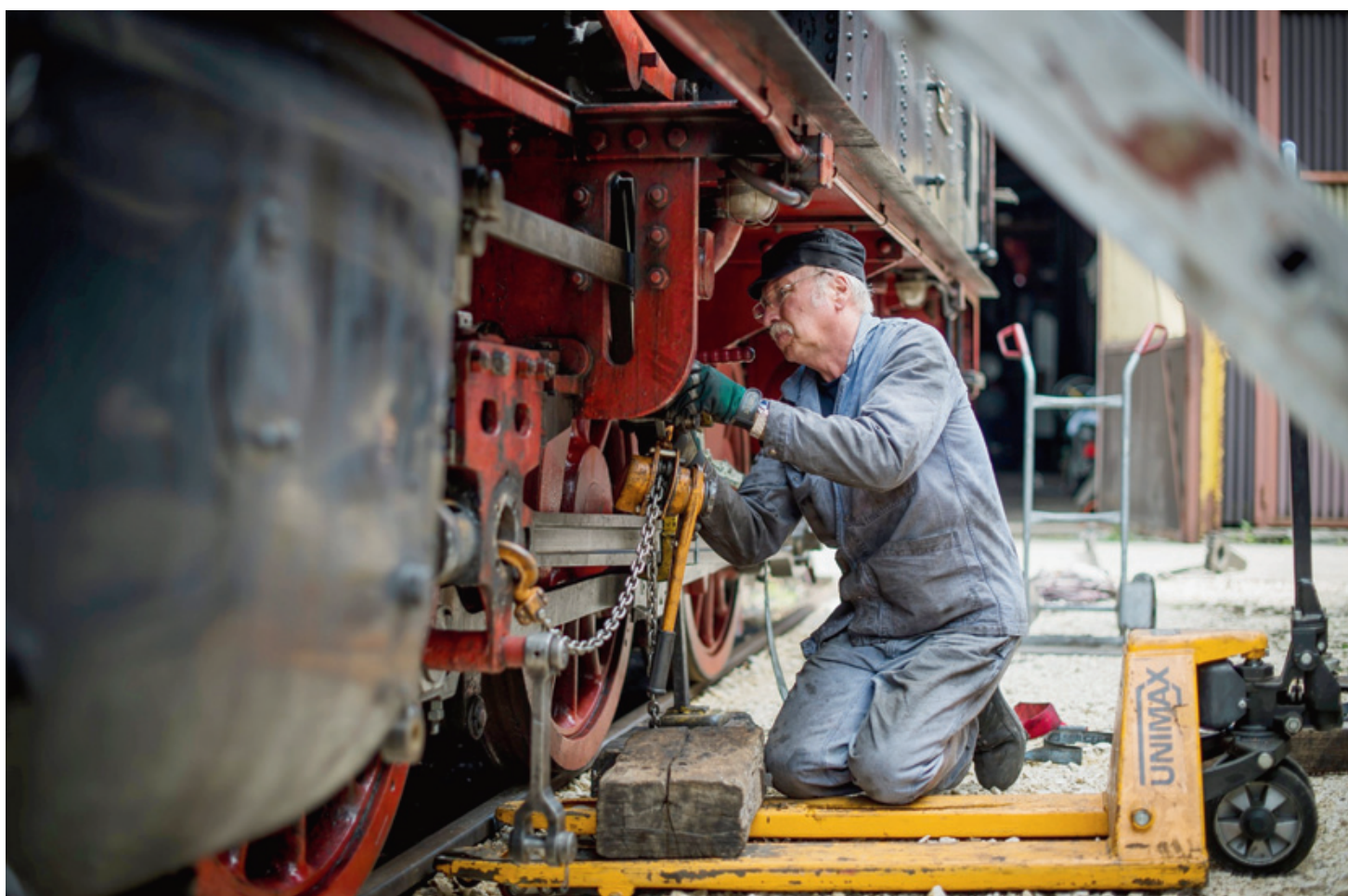
Jacques Descombaz remet en place la bielle motrice de la Krauss-Maffei de 1945. La motrice roulera le lendemain pour l'association «Un P'tit Plus».
