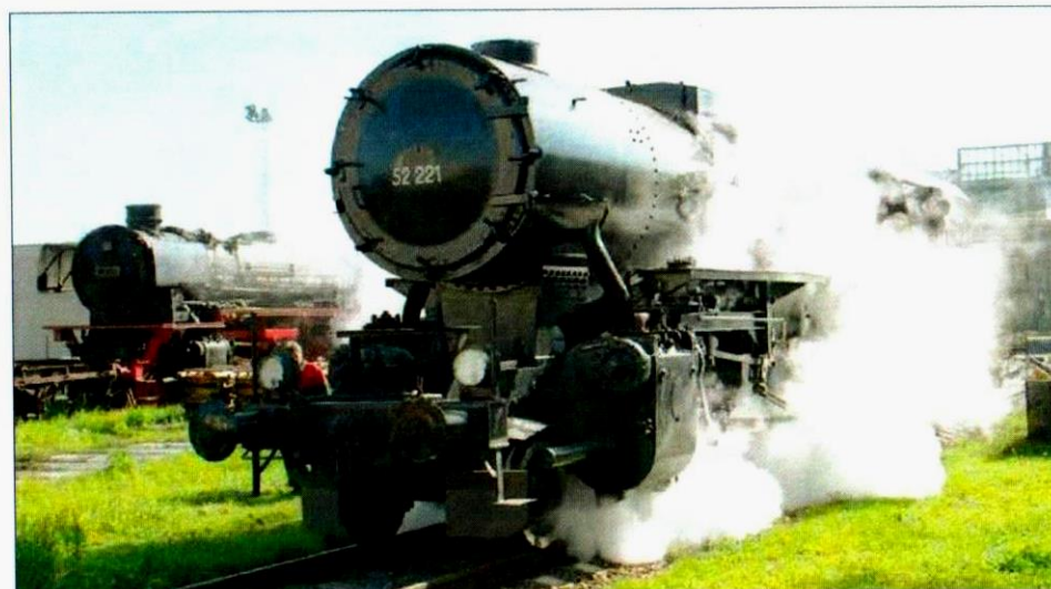
TCHÉQUIE La 52 521 lors de l'essai de ses soupapes au sortir des ateliers de rénovation. (SP-VAPEUR VAL-DE-TRAVERS)
