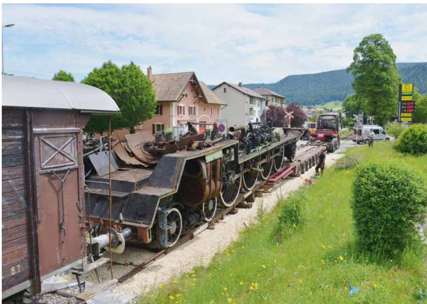
Le châssis de la locomotive à vapeur, en train d'être poussée sur la remorque.
