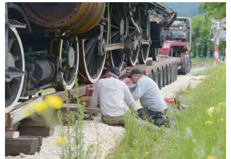
Jean-Claude Polliot et Luc Duverger en train de remplacer une cale défectueuse.
