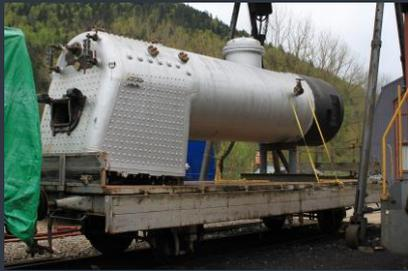
La chaudière de notre Slask, organe produisant la vapeur, est une construction neuve réalisée en République Tchèque. Encore abritée dans notre dépôt de St-Sulpice, la chaudière a été livrée sans sa carrosserie. Le carénage entourant la chaudière est appelé tôles d'enveloppe. Ces tôles reposent sur des profilés supports appelés crinolines. Ce travail de reconstruction est en cours de réalisation au VVT par nos membres.
